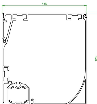
\* Flowzz 100 Classe 3, Pression du vent nominale max 11,0 daN / m<sup>2</sup>, Vitesse du vent max 50 km / h
